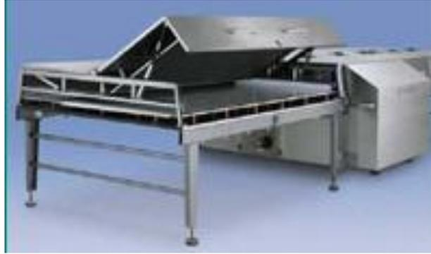
**Figure 15 - Tunnel de refroidissement**
