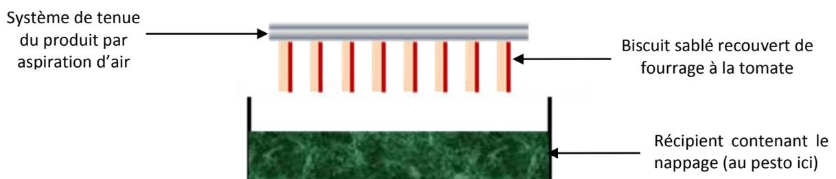
Figure 10 - Procédé de trempage pour napper les Triopéro
