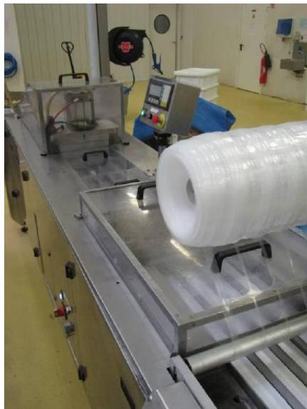
**Figure 22 - Thermoformeuse**
