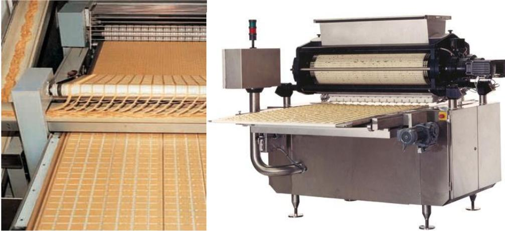
**Figure 13 – Machine à découper à cylindres rotatifs**
