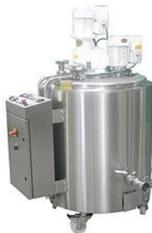
*Figure 18 - Cuve de mélange du nappage*
